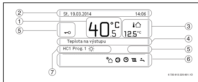
Obr. 6 Symboly ve standardním zobrazení (příklad zobrazení)
