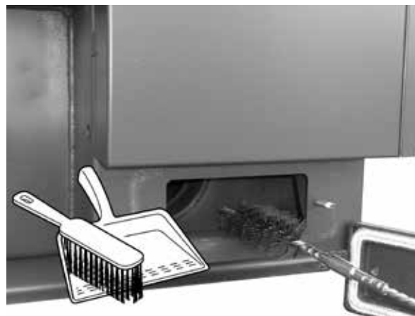
Ukázka čištění kouřového kanálu - spodní víčko
