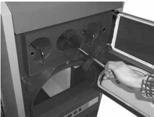
Vyčištění výměníku (trubkovic) vloženým kartáčem (u kotle D20P, D30P, D40P a D50P)
