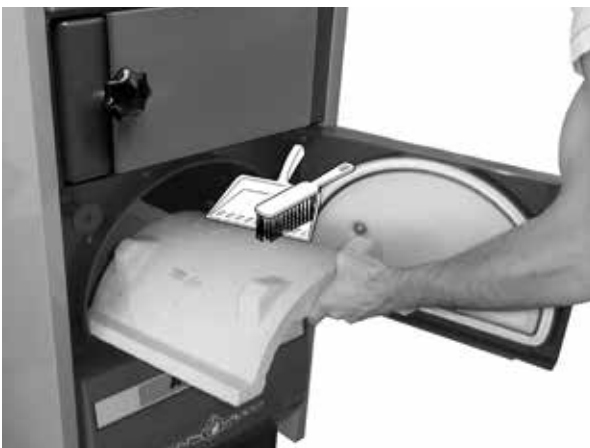
Čištění keramického spalovacího prostoru - klobouku
