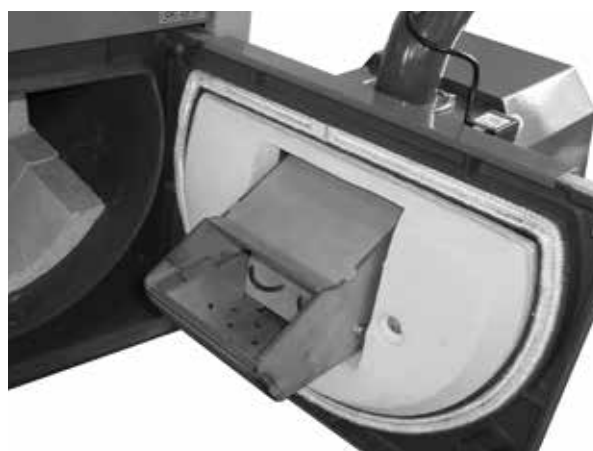
Otevřená spodní komora kotle při čištění spalovací komůrky hořáku ATMOS A25
