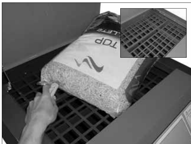
Ukázka standardního doplňování pelet z 15 kg pytlů. Ochranou mříž z kotle nikdy nevyjímáme
