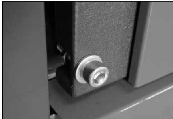
Dotážený zajišťovací šroub příkládacích dvířek
