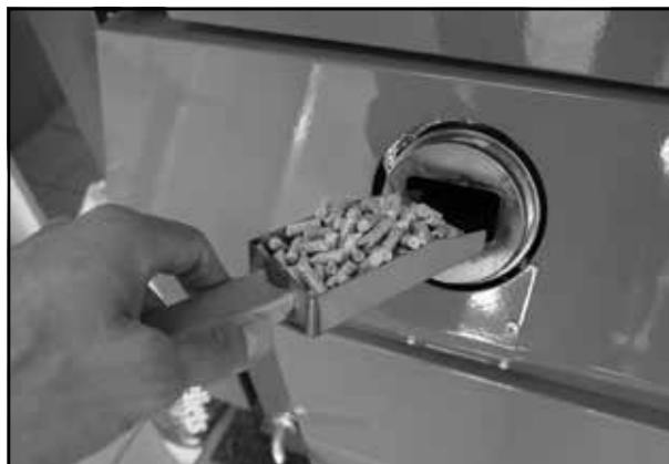
Ukázka vložení zapalovací dávky pelet do zapalovací komůrky
