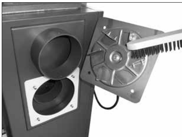
Ukázka čištění oběžného kola a kontrola kolmosti lopatek odtahového ventilátoru
