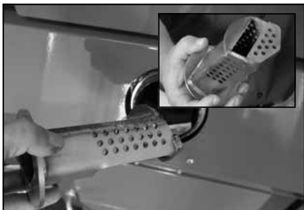
Ukázka vyndání zapalovací nebo zaslepovací komůrky
