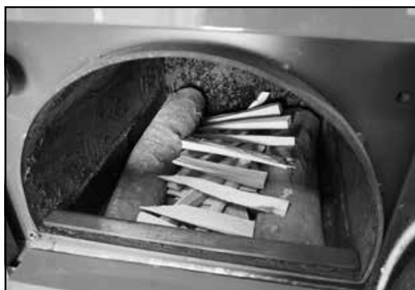
Naklazení třísek napříč komorou nad novinový papír
